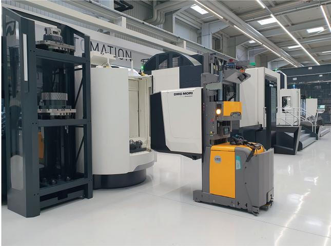
2 Ein autonom fahrendes Transportgerät PH-AGV belädt den Werkstückspeicher selbsttätig mit einem auf einer Palette aufgespannten Werkstück © Hanser
